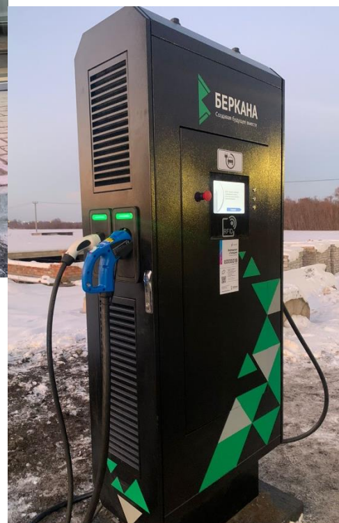
вид ЭЗС: DC, 40 кВт марка: Яблочков объект: сеть ЭЗС БЕРКАНА, г. Буинск (Татарстан)
