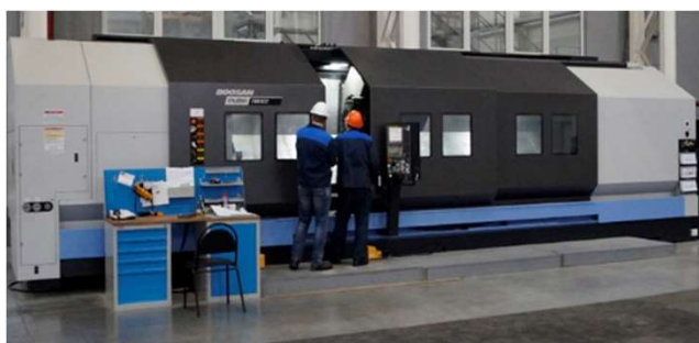
Горизонтальный токарный обраб. Центр с ЧПУ. МАХ габариты обрабатываемых деталей диаметром 750мм длиной 5100 мм. Массой до 8т.
