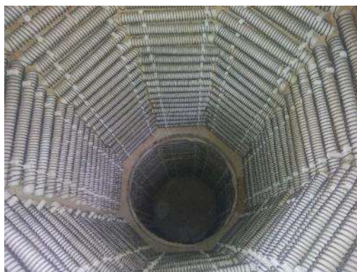
Печь для термообработки валов длиной до 8 м.
