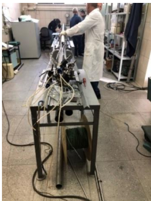
Совместная работа специалистов НПО «ЛУЧ» и ИРМ по сборке облучательного устройства
