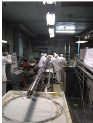
Подготовка облучательного устройства к загрузке в реактор
