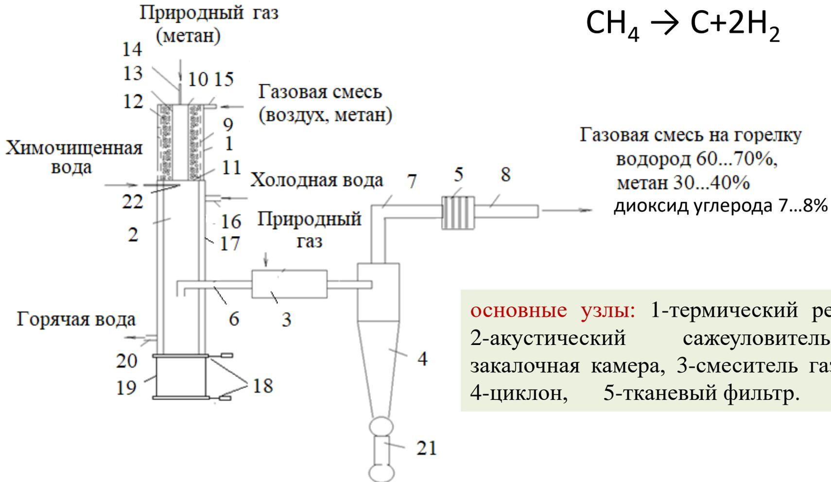
**основные узлы:** 1-термический реактор, 2-акустический сажеловитель - закалочная камера, 3-смеситель газовый, 4-циклон, 5-тканевый фильтр.
