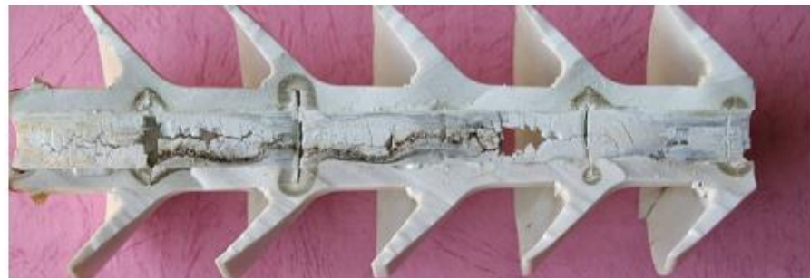
Внутренний дефект изолятора
