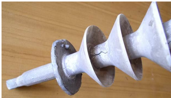
Трещина на поверхности изолятора
