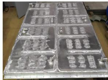
Крышка короба МФЭ с жидкостной системой охлаждения
