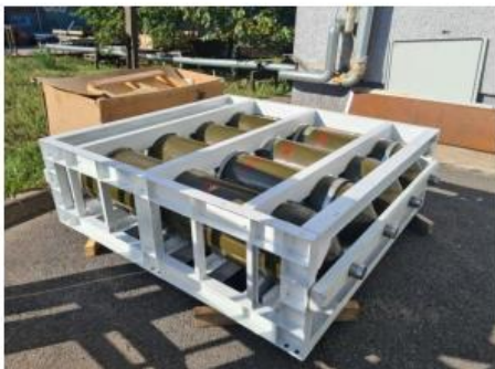
Баллонная система хранения водорода: моноблок с металлокомпозитными баллонами на раме
