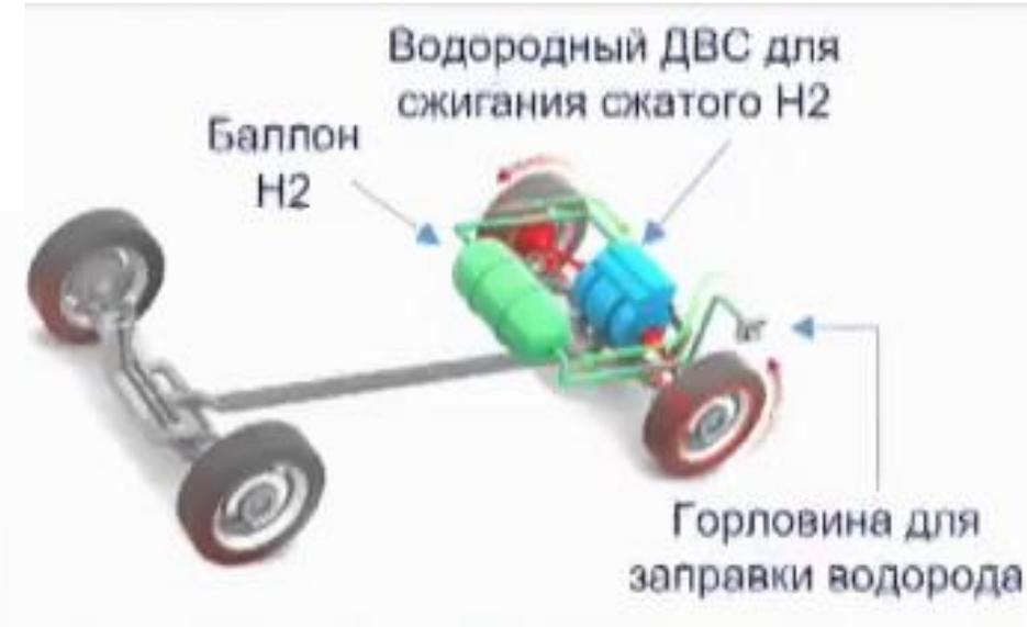
В России разработан **водородный двигатель ЯМЗ-535 H<sub>2</sub>** для автомобилей полной массой 8 т на базе газового.
