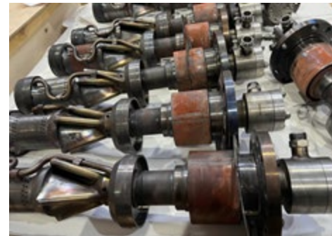
■ Выполнение восстановительного ремонта топливных форсунок Siemens SGT-800 (1 комплект)
