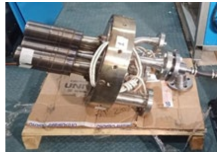
■ Выполнение восстановительного ремонта топливных форсунок GE MS5002E (6 комплектов)
