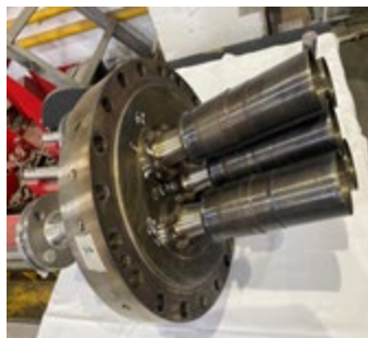
■ Выполнение восстановительного ремонта топливных форсунок GE MS5002E (6 комплектов)
