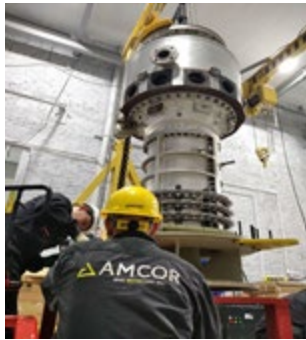
■ Капитальный ремонт ГТУ Solar Taurus 60 и редуктора
