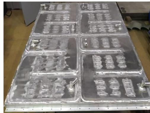
Крышка короба МФЭ с жидкостной системой охлаждения
