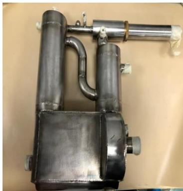
Система рециркуляции водорода: влагоотделитель (слева) и система в сборе (справа)
