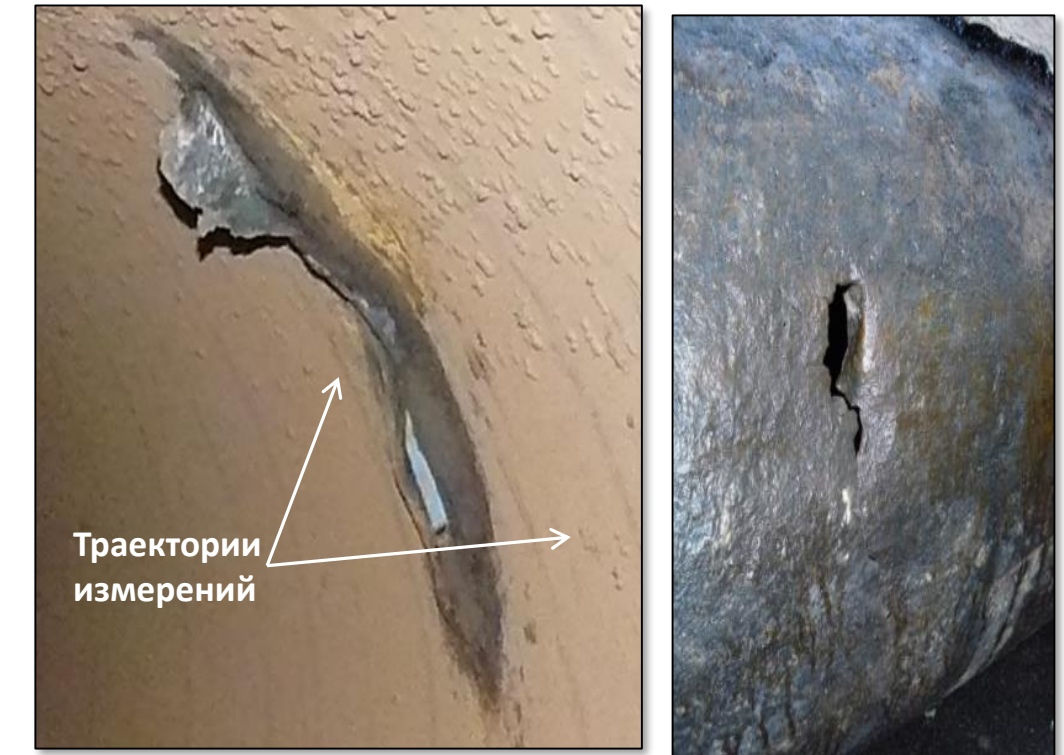
Пропущенный дефект между траекториями измерений
