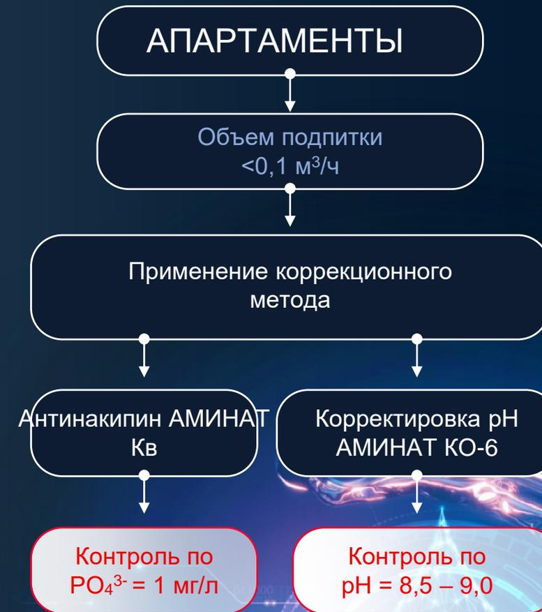
Дозирование реагентов осуществляется в трубопровод подпиточной воды по сигналу водосчетчика (пропорциональное дозирование)
