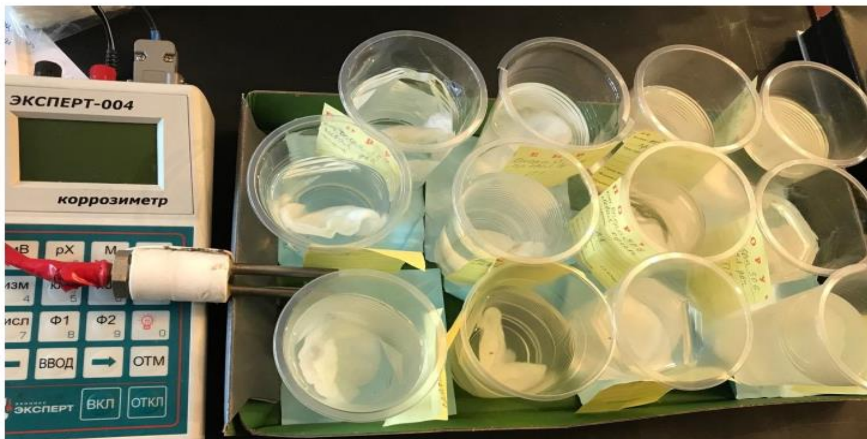
Рис. 4 Прибор ЭКСПЕРТ 004 (Коррозиметр) для экспресс-оценки скорости коррозии стали в жидких средах
