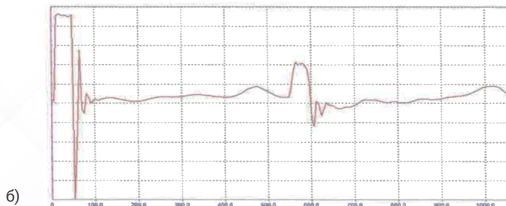
Рис. 4 – а) распределения ЧР в КЛ 110 кВ по телу кабеля (3 фазы); б) рефлектограмма фазы «А»
