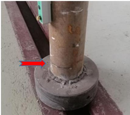
При фоновом воздействии, проведённые эксперименты по увеличению несимметричности модели показали снижение частоты и «разбежку» частот в сторону уменьшения при дефекте, близком к месту заземления. Двойная частота-признак несимметричности модели.
